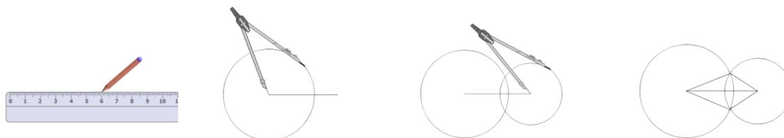
*Figure 1 : Illustration de la construction du triangle à la règle et au compas.*
